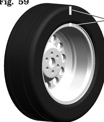
Señal de referencia en el NEUMÁTICO y señal de referencia en la LLANTA deben coincidir
