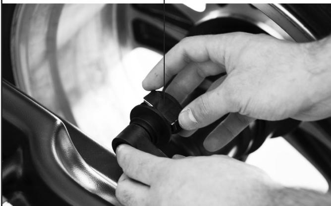
El acercamiento del peso a la posición de corrección se indica con el símbolo "flecha", más o menos distante, que aparece en el display referido a la posición interna /externa en el cual se está operando. Al alcanzar la posición exacta, aparece el símbolo "dos flechas contrapuestas" (véase Fig. 28).
