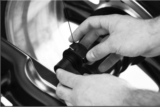
La posición de aplicación del peso que no se encuentre exactamente a "horas 12" (**Fig. 34**) se compensa automáticamente.
