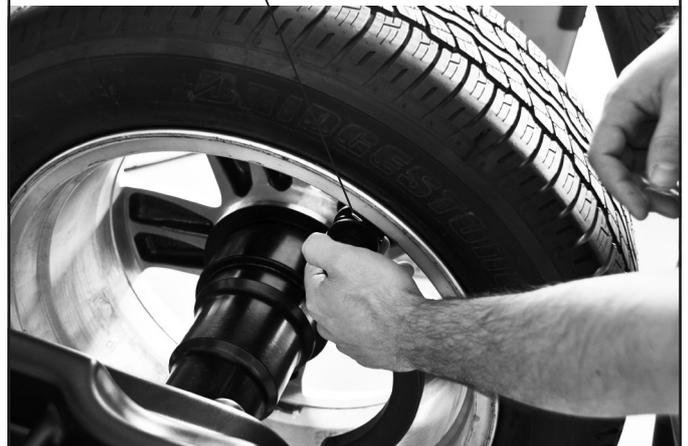
Llevar el brazo del calibre distancia-diámetro en posición de reposo.
