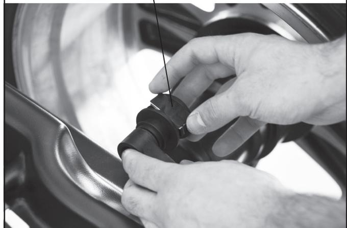
**Fig. 41** Aplicar el peso en la posición en la cual la pinza del peso toca la rueda
