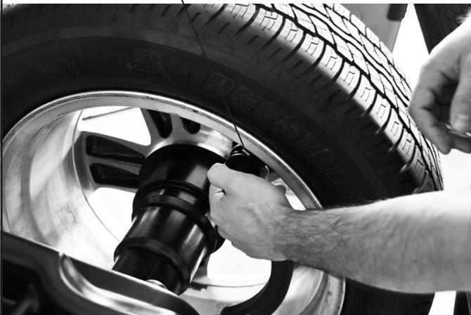
Al finalizar el procedimiento es posible controlar las condiciones de equilibrado de la rueda, realizando un balanceo de control.
